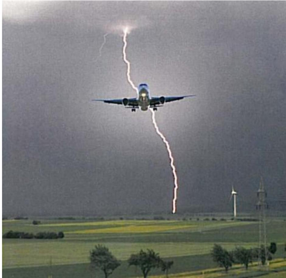
Flug unter einer Gewitterwolke. Die im Flugzeug auftretenden Feldstärken hängen vom Schichtwiderstand der Außenhaut und der Stromstärke des Blitzes ab.
